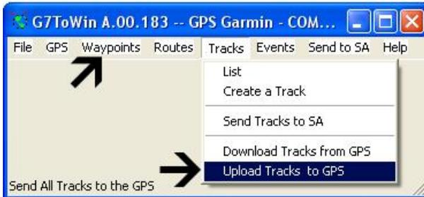
**Bild 7:** G7ToWin – Tracks und Waypoints zum GPS-Empfänger übertragen
