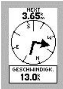
Oben auf der Navigationsseite wird die Entfernung zum Ziel bzw. zum nächsten Wegpunkt angezeigt. Unten finden Sie ein Feld mit weiteren selbstwählbaren Informationen, in unserem Beispiele die aktuelle Geschwindigkeit.
