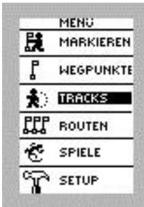
Wählen Sie dazu auf der **Menüseite** des GPS-Empfängers mit den entsprechenden Tasten den Menüpunkt **TARCKS** (Bild links) und im darauffolgenden Menü die gewünschte Wegaufzeichnung (Bild rechts).
